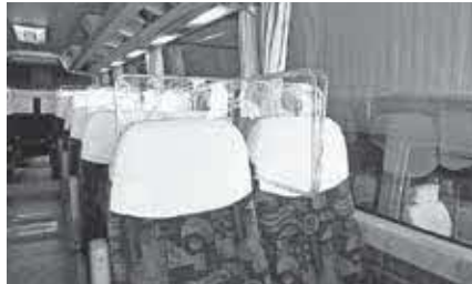
シート間に飛沫防止パネルを設置
